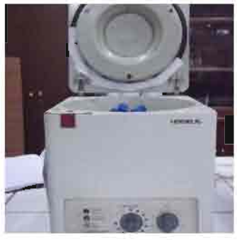
Penghomogenan dengan sentrifus dengan kecepatan 7500 rpm selama 5 menit
