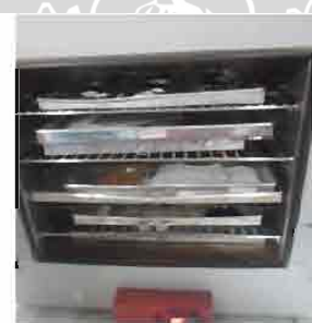
Pengeringan sampel selama 3 jam dengan suhu 105°C dengan tutup setengah terbuka didalam oven
