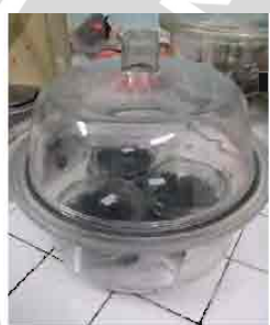
Pendinginan sampel kering selama 15 menit dalam desikator
