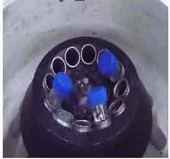
Peletakkan cuvet berisi sampel kedalam sentrifus
