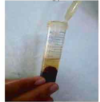
Penghilangan fase minyak pada sampel beserta pengukuran volumenya
