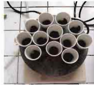
Pengarangn diatas hotplate hingga sampel tidak berasap
