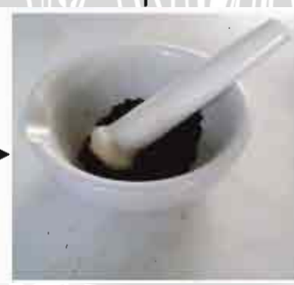
Penghalusan sampel dari kadar lemak dengan mortal dan alu
