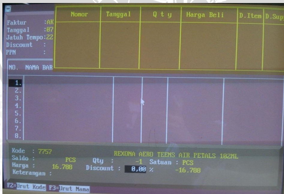
Gambar 4.28 Foto Display Komputer Pembelian Kredit – Field jumlah barang dapat diisi negatif, sub total juga negatif
