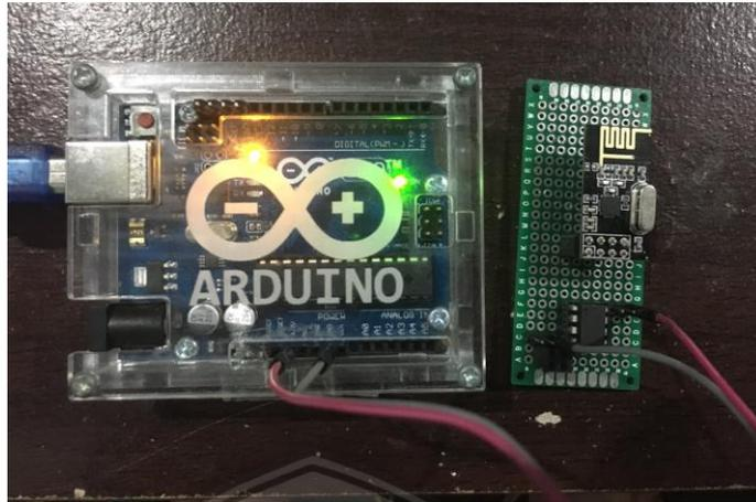
**Gambar 5.16** Modul komunikasi terhubung dengan *core* modul menggunakan komunikasi serial (UART)
