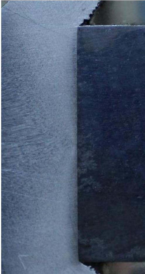
Gambar 5.33. Batas Sambungan pada Proses Las gesek dengan Tekanan Gesek 40 MPa dan Waktu Gesek 7 Detik
