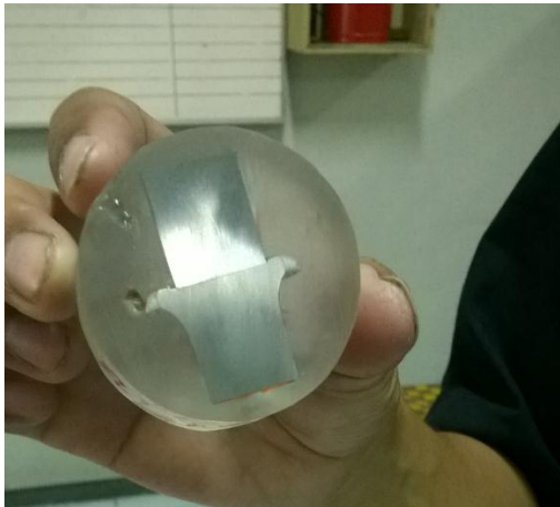
Gambar 4.18. Potongan Sambungan pada Benda Kerja setelah Dicetak pada Resin
