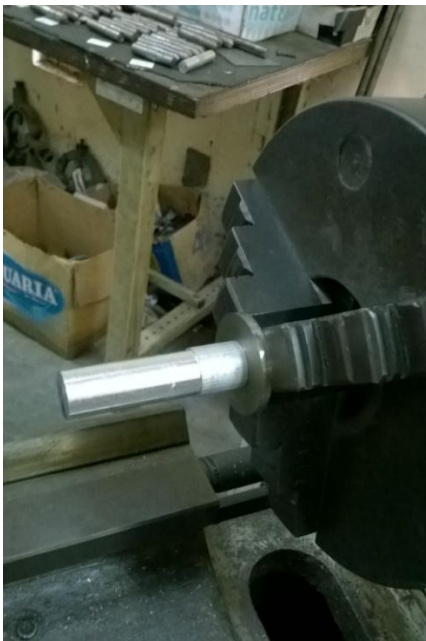
Gambar 4.7. Pemasangan Benda kerja 1 dengan Ring pada Pencekam
