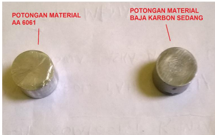
Gambar 4.14. Spesimen Uji untuk Pengujian Komposisi Kimiawi
