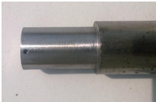
Gambar 4.15. Lubang Peletakan Ujung Termokopel pada Benda kerja 2
