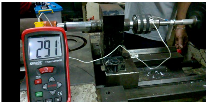
Gambar 4.16. Proses Pengukuran Temperatur pada Saat Proses Pengelasan
