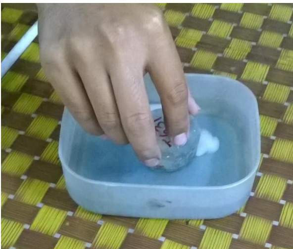
Gambar 4.20. Proses Perendaman pada Cairan Etsa
