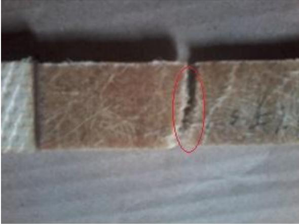
Gambar 4.3 Contoh hasil foto makro spesimen
