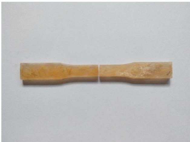
Gambar 4.1 Contoh hasil spesimen uji tarik
