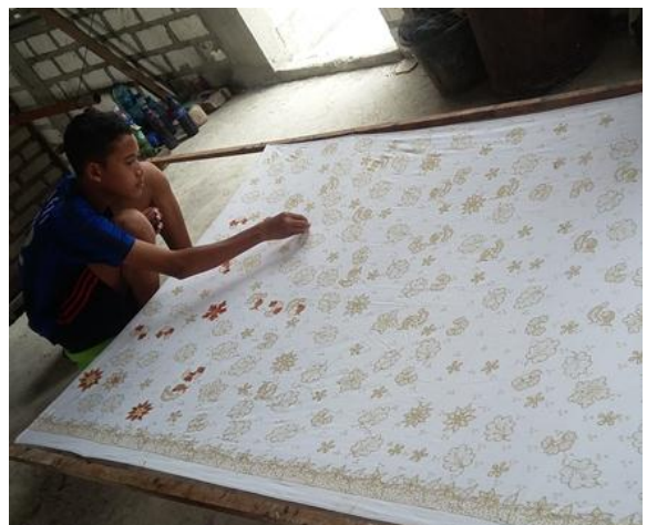
Gambar 4: Foto proses pemberian warna pada gambar batik yang sebelumnya telah ditutup menggunakan malam. Sumber : Data Primer Hasil Observasi 2017
