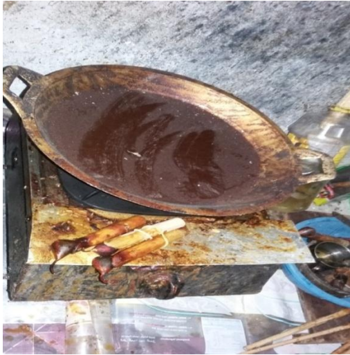
Gambar 1: Foto alat produksi berupa canting, kompor, wajan dan malam dalam pembuatan batik tulis lamongan. Sumber : Data Primer Hasil Observasi 2017
