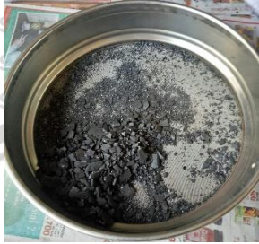
Gambar 4.2 Arang blotong dan tempurung kelapa hasil karbonisasi
