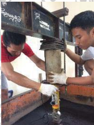
Gambar 3.8 Pemasangan hydraulic jack dan load cell .
