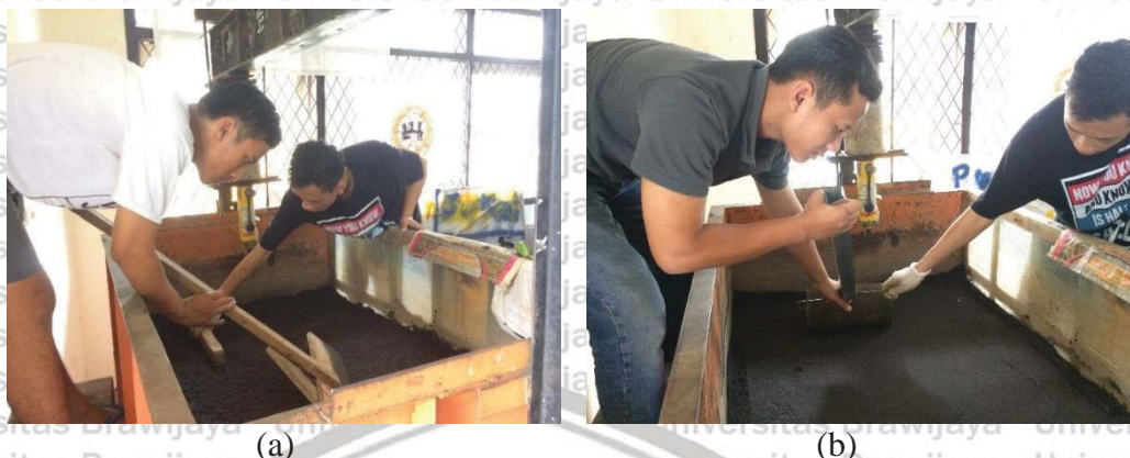
Gambar 3.4 (a) sebelum dilakukan pemadatan pasir diratakan terlebih dahulu; (b) proses pemadatan pasir dengan silinder beton.
