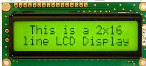
**Gambar 2. 10** Bentuk Fisik LCD 16x2
