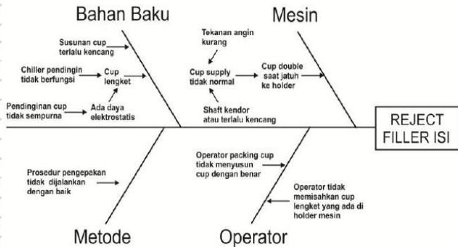
**Gambar 2.12.** Diagram sebab akibat jenis cacat *reject filler isi* (Sumber: Ramadhani *et al.*, 2014)
