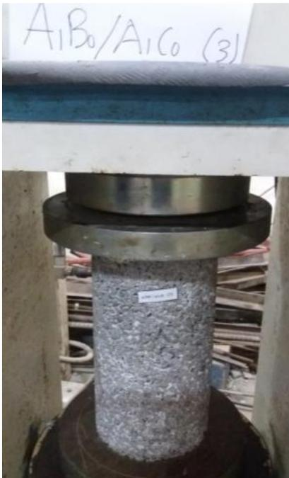
*Gambar 4.7* Uji Tekan Benda Uji yang Menggunakan *Normal Mixing Approach*
