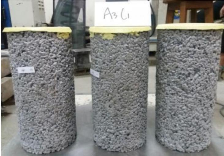
*Gambar 4.4* Benda Uji Silinder Beton *Porous* dengan Metode *Two-Stage Mixing Approach*
