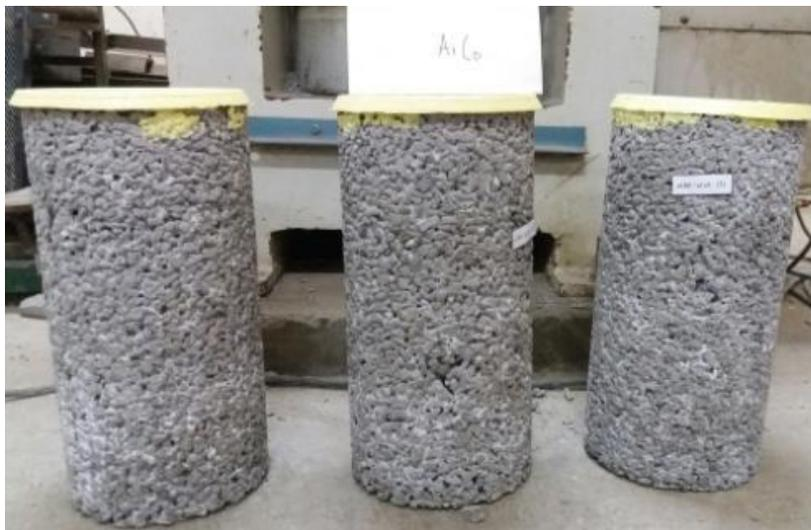
Gambar 4.2 Benda Uji Silinder Beton *Porous* dengan Metode *Normal Mixing Approach*
