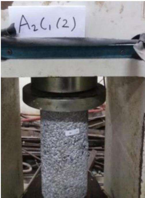
Gambar 4.9 Uji Tekan Benda Uji yang Menggunakan *Two-Stage Mixing Approach*
