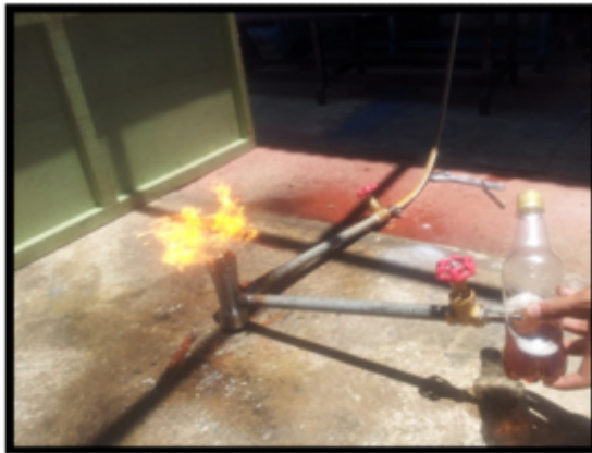
Gambar 2. Oli bekas dicampur solar untuk pembakaran awal.
