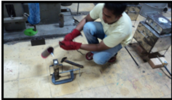
Gambar 8. Penuangan logam aluminium cair ke dalam cetakan.
