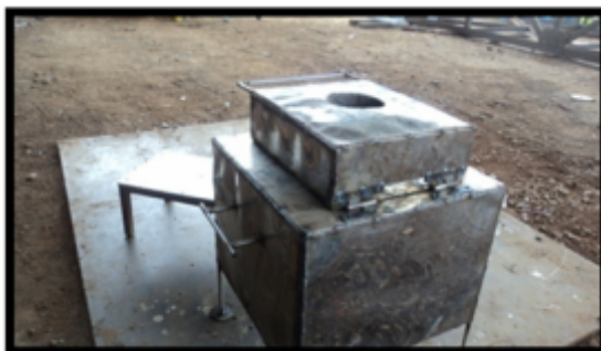
Gambar 3. Membangun tungku peleburan logam.
