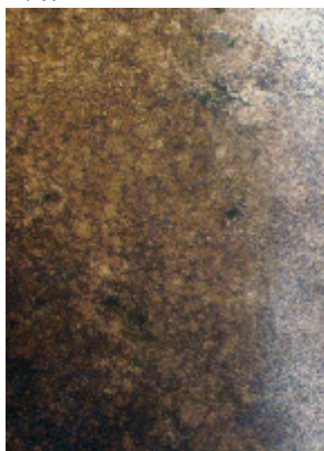
Gambar 5. Struktur mikro logam las, fasa ferite dengan bentuk acicular, perlit dan sedikit partikel sementit. Etsa Nital 2%.
