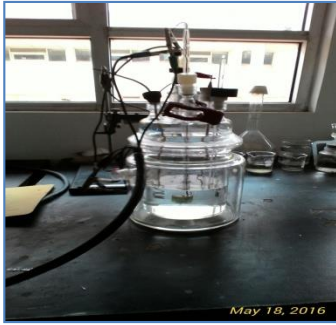
Gambar 1. Sel polarisasi dengan menggunakan 3 elektroda
