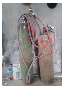
Oksigen-Asetelin untuk pemanas saluran penuangan
