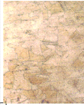
Gambar 5. Foto Struktur Mikro Bone Plate A, etsa kalling reagent
