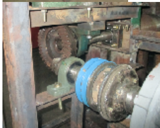
Gambar 9. Penghubung putaran pada pencacah tipe reel
