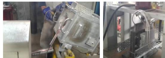
Gambar 4. Proses penuangan dan penekanan material coran.
