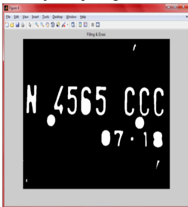
Gambar 13. Proses Filling dan Erosi
