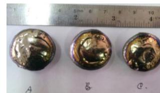
Gambar. 2. Spesimen ingot hasil remelting
