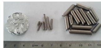
Gambar. 1. Raw Material ingot paduan titanium Ti, Al dan Mo
