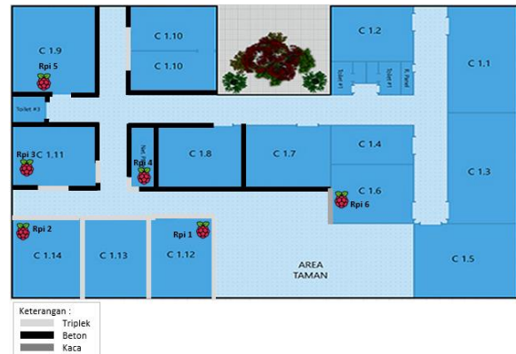
Gambar 4.1 Topologi jaringan dalam pengujian
