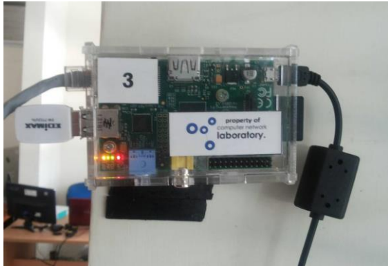
Gambar 3.3 Raspberry Pi Seri B dengan Modul WiFi Edimax
