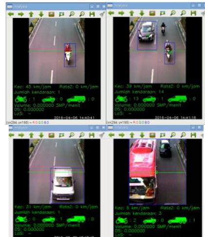
Gambar 9. Antarmuka Sistem Pada *Serial monitor*
