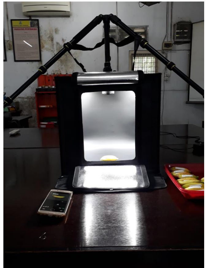
Gambar 1. Computer vision system (CVS) yang dikembangkan
