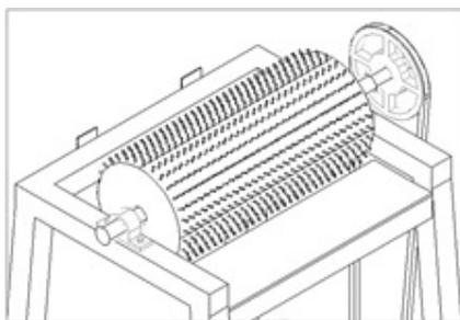
Gambar 3. Pemasangan silinder parut pada rangka dan *pulley*
