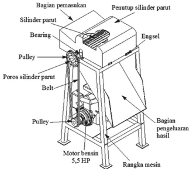
Gambar 2. Desain konstruksi mesin pemat sagu
