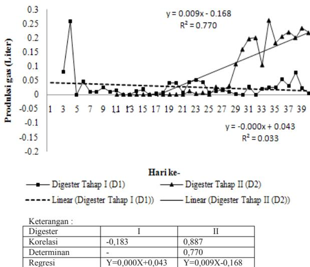
Gambar 2. Produksi biogas kombinasi 80<sub>LC</sub>:20<sub>LA</sub> pada D1 dan D2
