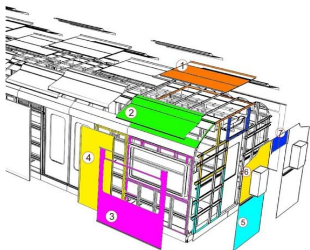
Gambar 8. Posisi instalasi panel
