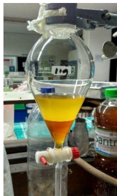
Gambar 1. Produk sintesis biodiesel (lapisan atas adalah metil ester/produk biodiesel dan lapisan bawah gliserol)
