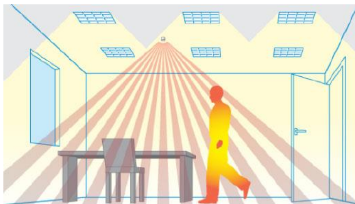
Ilustración 14 Funcionamiento del sensor PIR
