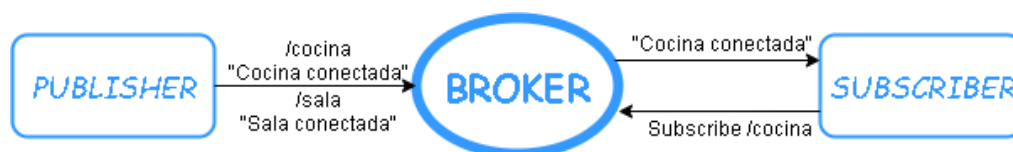
Ilustración 17 Diagrama de funcionamiento Pub/Sub.
