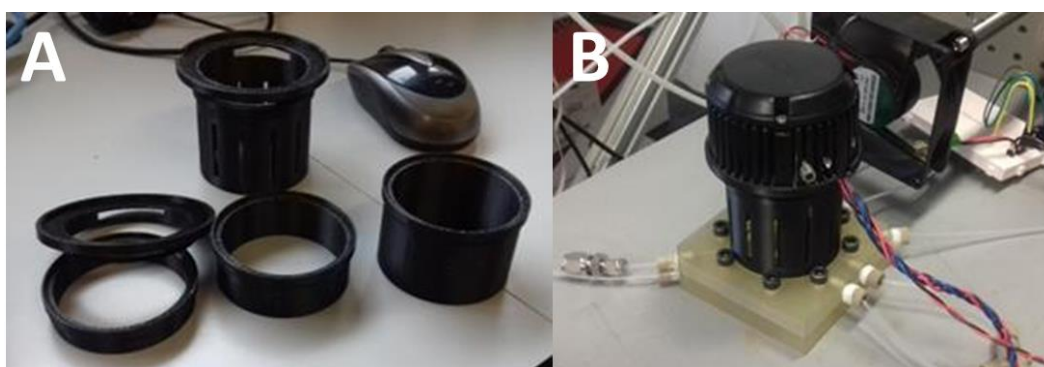
Figura 2-29 – Distintos espaciadores para variar la distancia del LED al catalizador (A); Montaje del LED en su disipador con un espaciador, sobre la celda de reacción y con ventilación externa (B).
