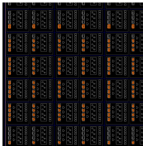
Figura 4. Submatriz de osciladores con configuración vertical que componen la RO-PUF.
