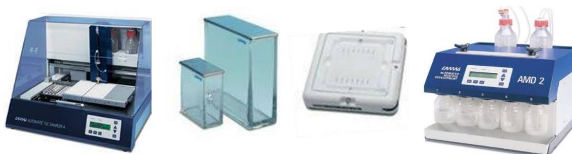
Figura 1. Se muestra de izquierda a derecha los siguientes instrumentos explicados anteriormente: AT4, cubetas tradicionales, cámara de elución horizontal y AMD.
