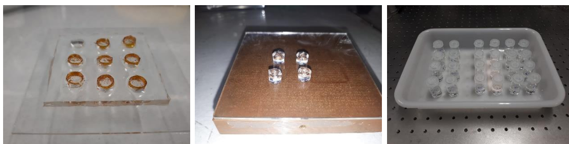
Figura 8: Izquierda: Moldes de kapton. Centro: Cilindros de hidrogel una vez curados. Derecha: Botes que contienen los cilindros de hidrogel sumergidos en PBS.
