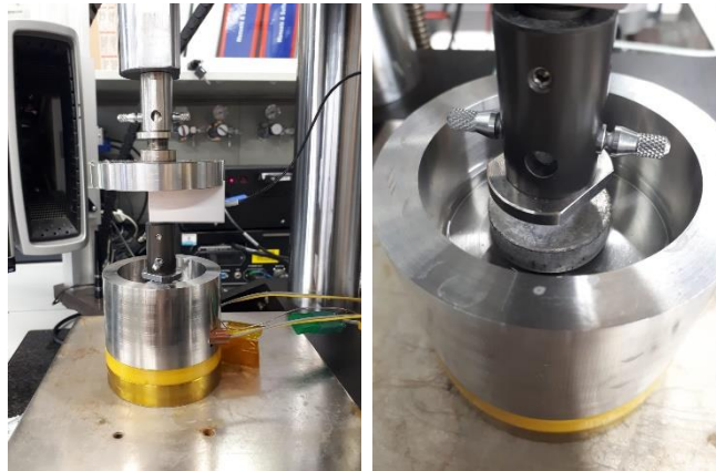
Figura 9: Izquierda: Utillaje de compresión. Derecha: Plato de compresión presionando el hidrogel sumergido en PBS a 37 °C.
