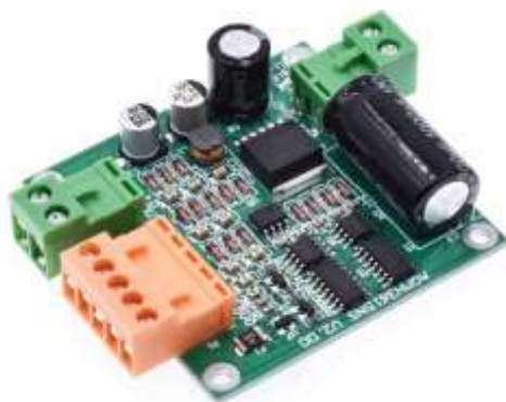
Ilustración 31 Puente H escogido - Precio: 17.2€ (importado)
