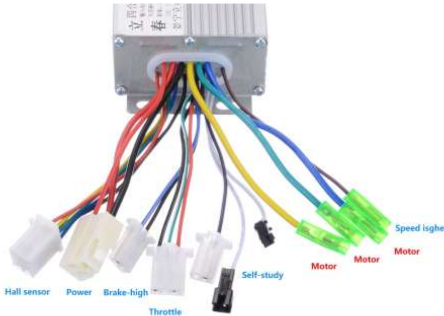
Ilustración 30 Detalle de las conexiones
