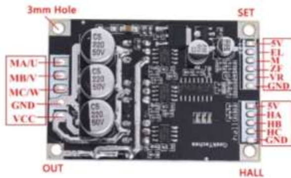
Ilustración 32 Puente para DC Brushless - Precio: 9.9€ (importado)
