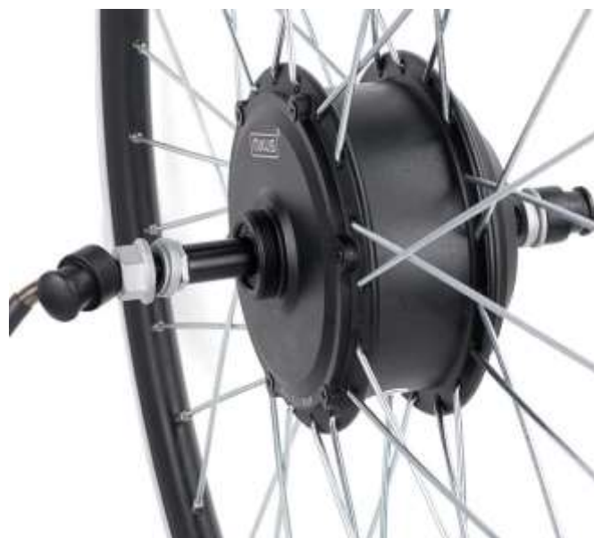
Ilustración 22 Imagen del motor colocado en la rueda
