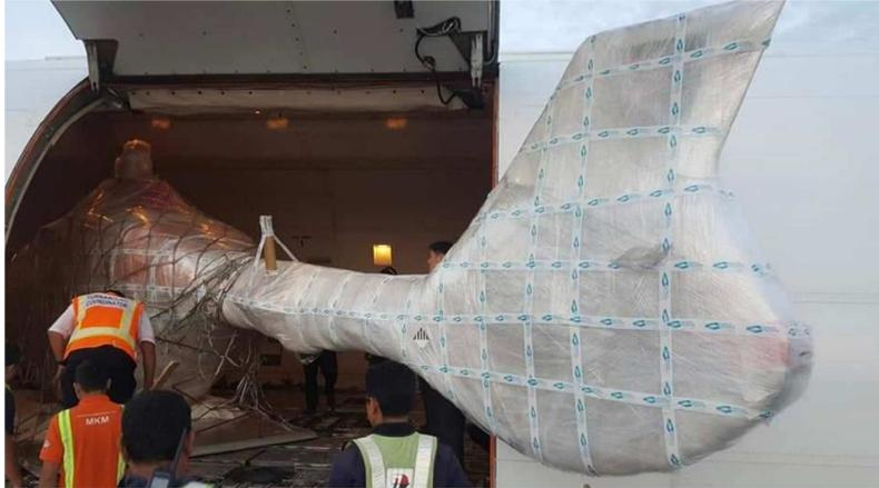
Ilustración 7 Transporte de helicóptero en Boeing 747F (1). Fuente: Saudia Airlines
