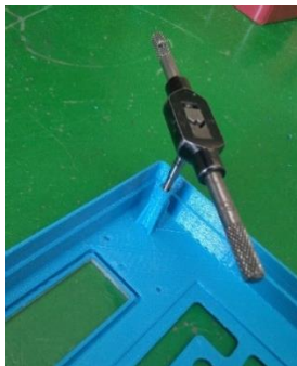
Figura 90: Roscado de los pasadores de la tapa
