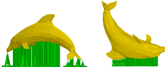
Figura 114: importancia de la orientación en la fabricación de piezas
