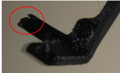
Figura 68: Rotura en el extremo de la unión
