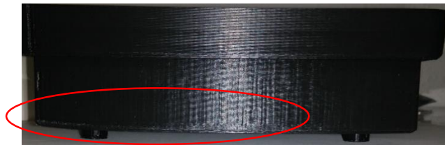
Figura 82: Combad de la base, por separación de la placa de impresión
