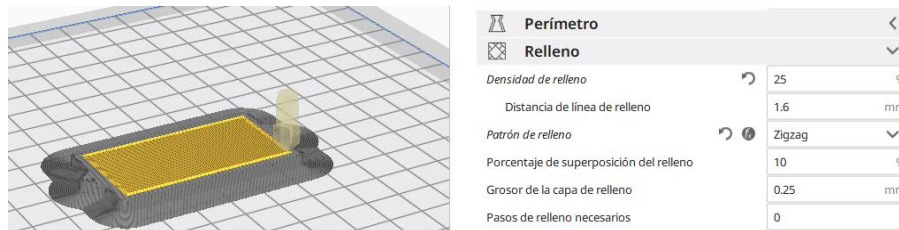
Figura 62: Parámetros de la tapa de la pila
