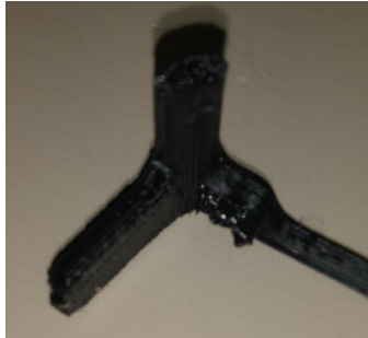
Figura 67: Rotura del orificio para el tornillo
