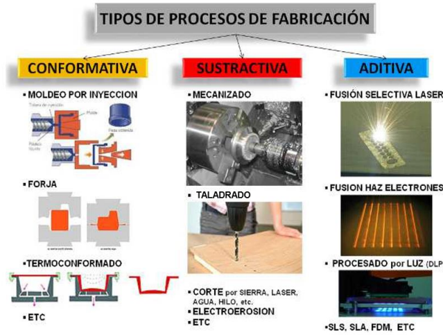
Figura 107: Clasificación de los procesos de fabricación según el modo de procesar el material para obtener la pieza
