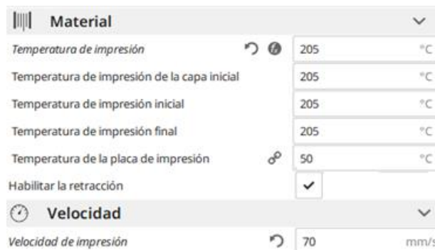
Figura 57: Parámetros de material y velocidad de impresión en Ultimaker Cura
