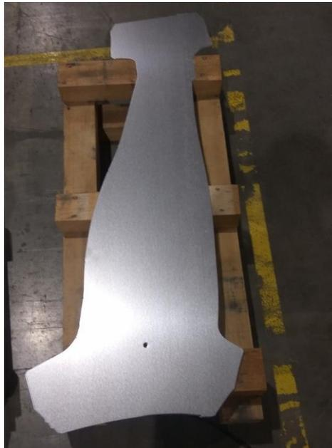
*Ilustración 7: Preforma o blank para Hot Forming*
