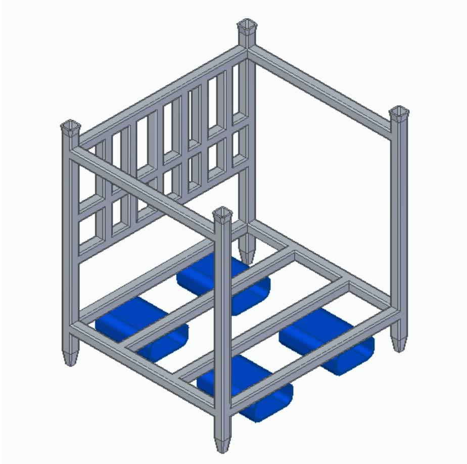
*Ilustración 33: Estructura rack almacenamiento*
