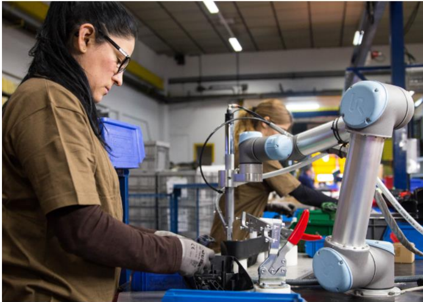
Figura 2.4: Operaria y cobot comparten espacio de trabajo en la industria [6].
