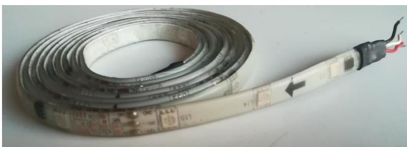
*Figura 5.5: Tira de LEDs RGB direccionable*
