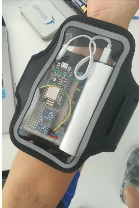
*Figura 4.15: Placa utilizada en la actuación insertada en el brazalete*
