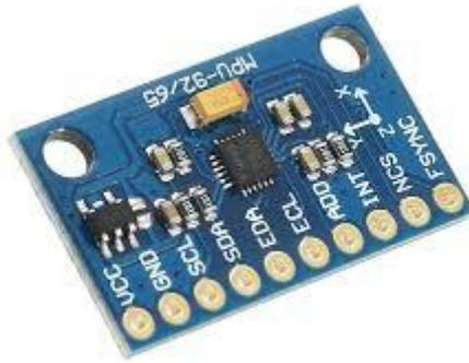
*Figura 3.1: Módulo MPU 9250 de InvenSense*
