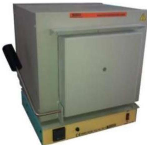
Figura 3. Horno de mufla usado para volátiles y cenizas.
