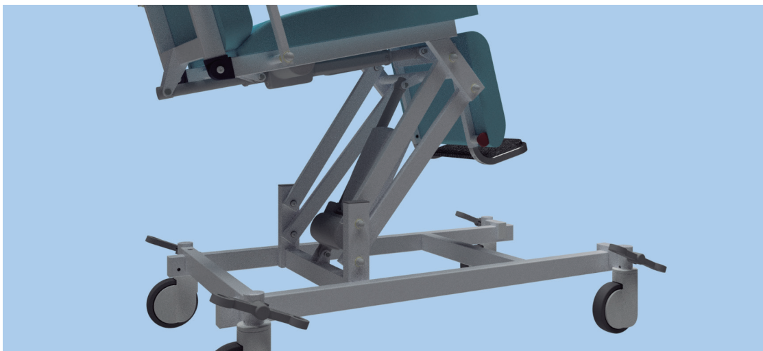
Imagen 11 - Montaje del elevación
