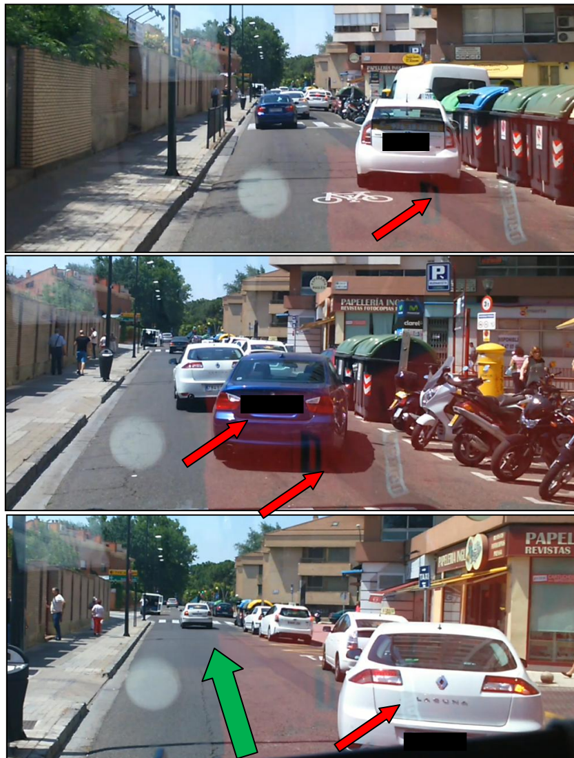
Figuras 79, 80 y 81. Vehículos generando un Corredor de Emergencia en vía de 1 carril.
