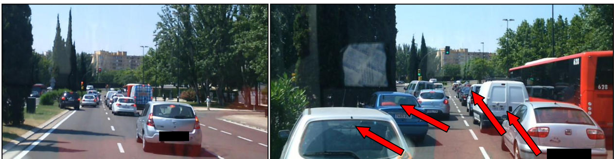
Figuras 43 y 44. Realización de un Corredor de Emergencia en vía de 3 carriles.
