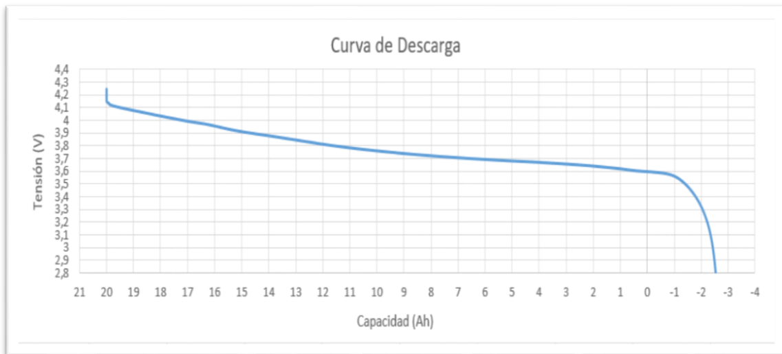
Ilustración 120 (Banco de pruebas – Carga electrónica - Curva de Descarga - Ah)
