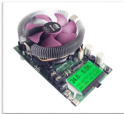
Ilustración 102 (Carga electrónica programable 20 Amperios)
