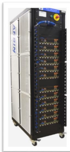
Ilustración 16 (Equipo de test de 96 canales)
