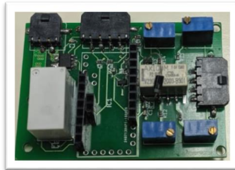
Ilustración 68 (Placa para el control de la fuente por MCU)
