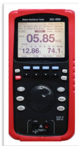
Ilustración 11 (Multímetro de resistencia interna y registrador de datos)
