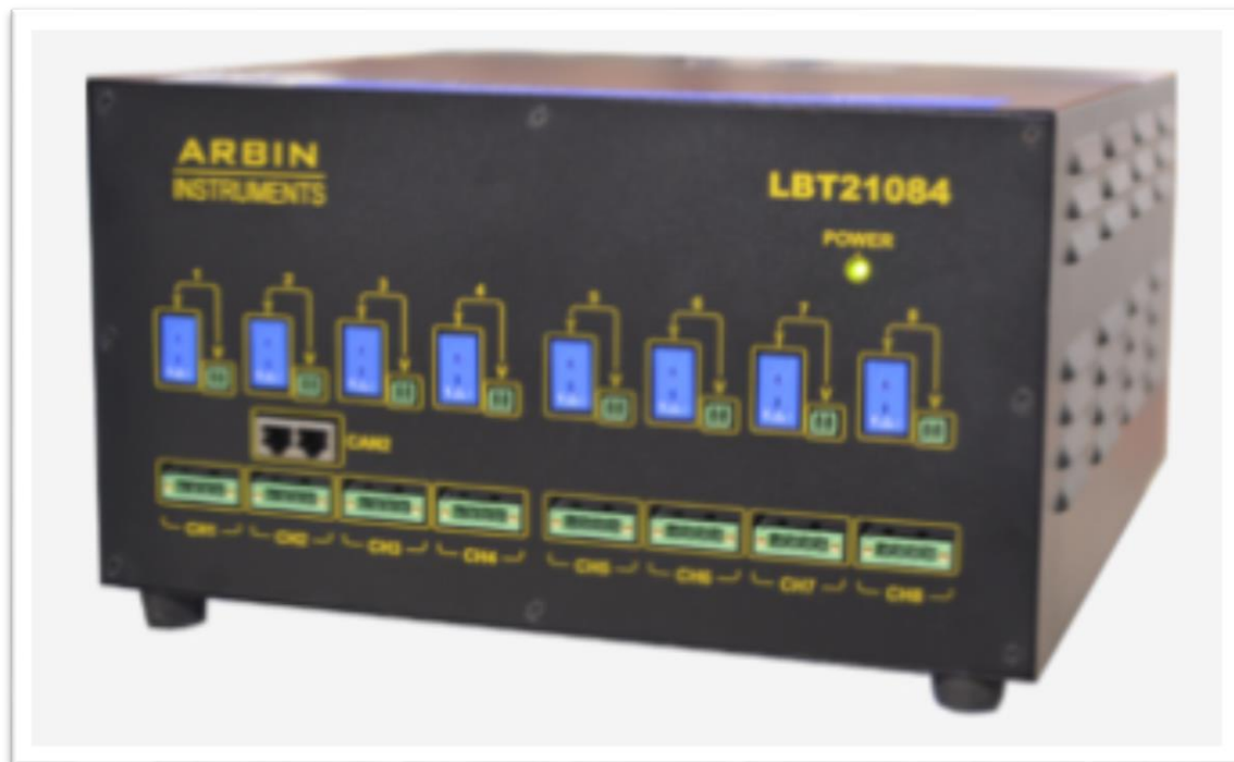
Ilustración 15 (Equipo de test Arbin Carga / Descarga)
