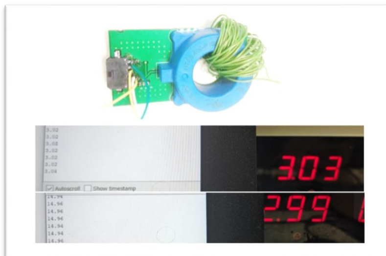
Ilustración 76 (Calibrado del sensor de efecto hall)
