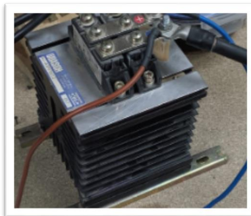
Ilustración 50 (Disipador de aluminio para el puente de diodos)
