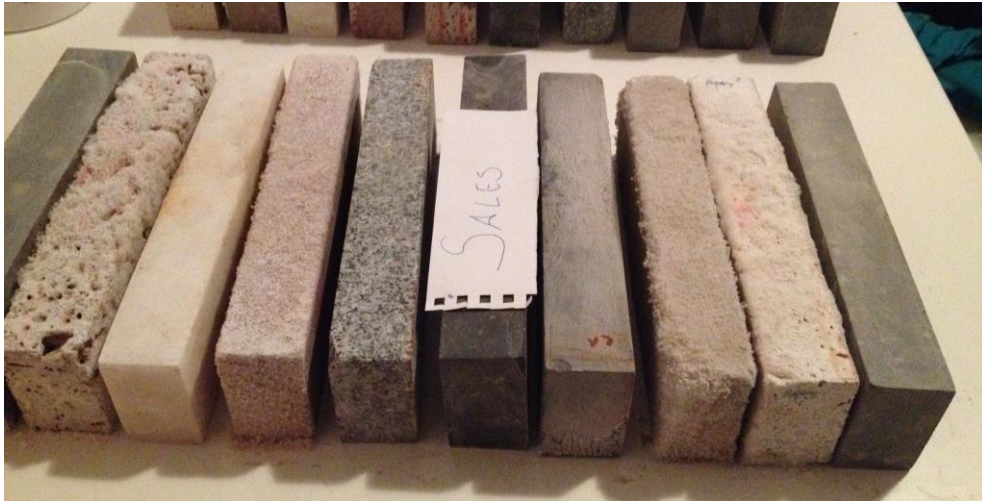
Figura 23. Aspecto visual de las probetas afectadas tras un envejecimiento acelerado por cristalización de sales.
