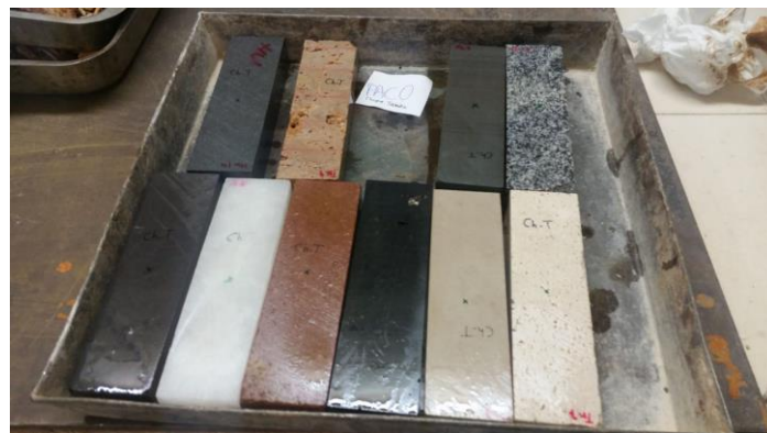
Figura 9. Probetas sometidas a choque térmico.
