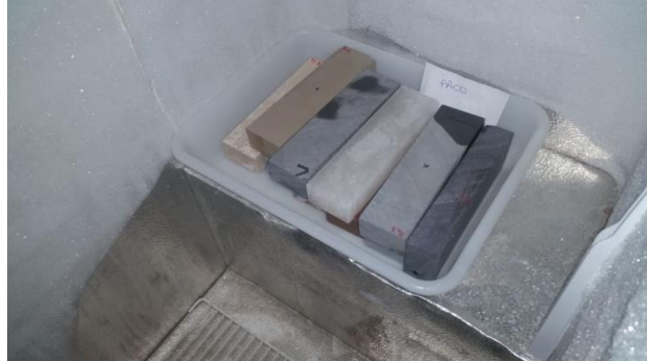
Figura 10. Probetas medidas en el congelador durante la etapa de hielo.
