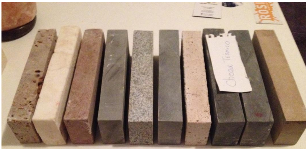
Figura 25. Aspecto visual de las probetas afectadas tras un envejecimiento acelerado por choque térmico.
