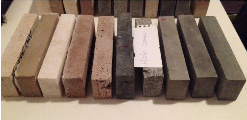
Figura 27. Aspecto visual de las probetas afectadas por el envejecimiento acelerado por hielo-deshielo.
