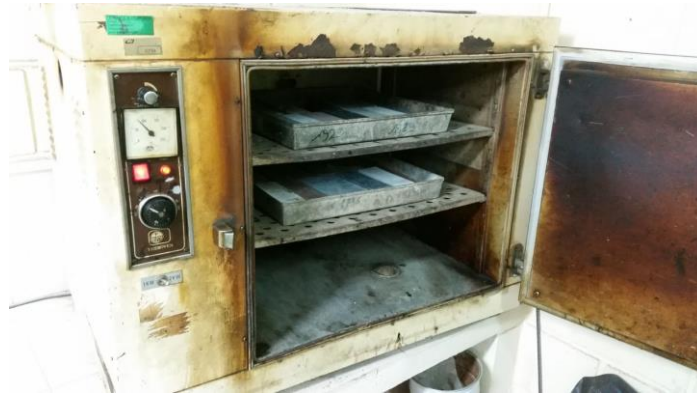
Figura 8. Horno calefactor con probetas sometidas a choque térmico y cristalización de sales
