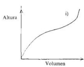
**Solución:** Frasco de tinta, f); frasco cónico, d); embudo taponado, b); cubo, a); frasco de evaporación, i); vaso, e). Las tres gráficas sobrantes corresponden a los recipientes de la derecha.
