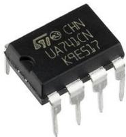
realizan **operaciones matemáticas**, como por ejemplo en circuitos montados a base de amplificadores sumadores, diferenciadores, integradores, comparadores, etc. Él es la base de electrónica analógica. El A.O. más usado debido que es muy barato y sencillo de usar es el 741(7- pines funcionan, 4-
