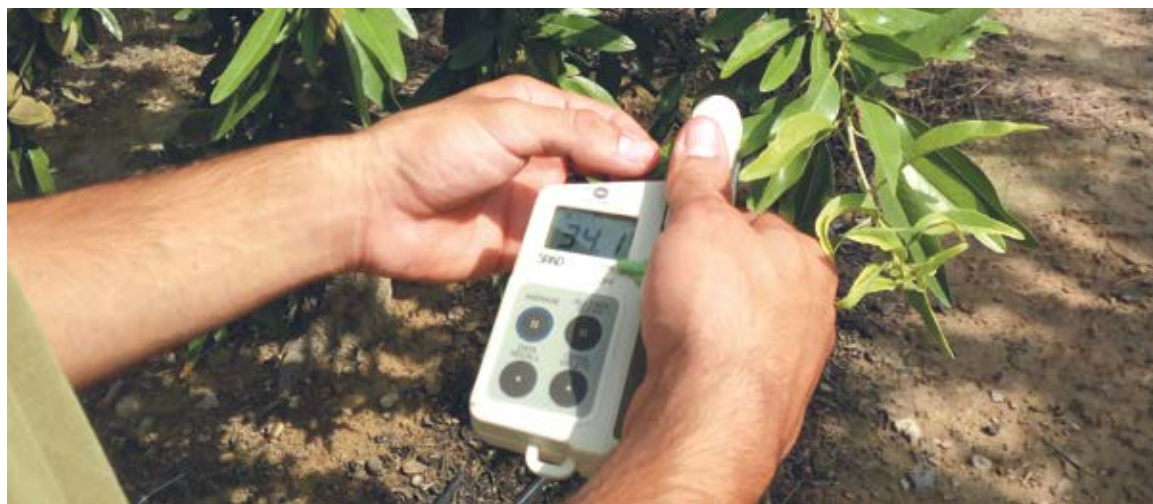
Foto 6. Medición del contenido en clorofila en hoja mediante el SPAD en verano de 2018.
