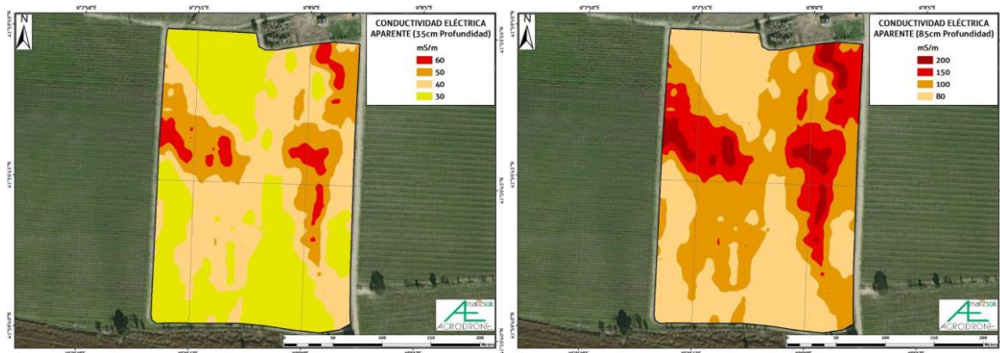
Imagen 9A. Conductividad eléctrica a 35 cm de profundidad. Imagen 9B. Conductividad eléctrica a 85 cm de profundidad (Agrodrone, 2018).
