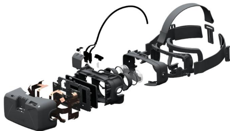
Figura 1.4. Vista expandida de las gafas Oculus Rift DK2 [14]
