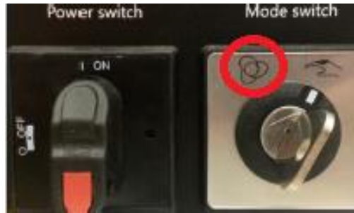
Figura 1.8 Selección del modo automático en el IRC5
