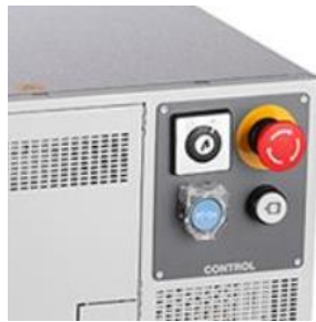
Figura I.14 Seta de emergencia del controlador IRC5
