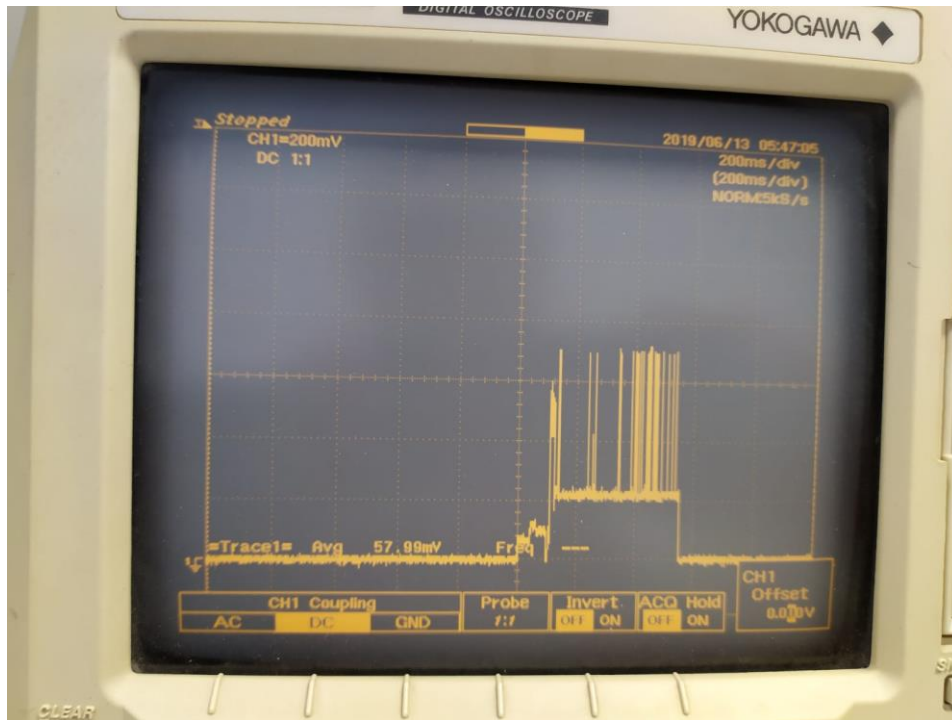
Figura 16. Consumo con los módulos próximos y usando el protocolo UDP
